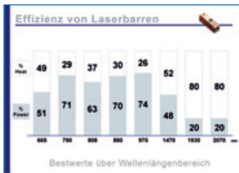
Graph 1 zeigt die neuesten Resultate bei der Effizienzsteigerung der HLDLs über den jetzt verfügbaren Wellenlängenbereich.
